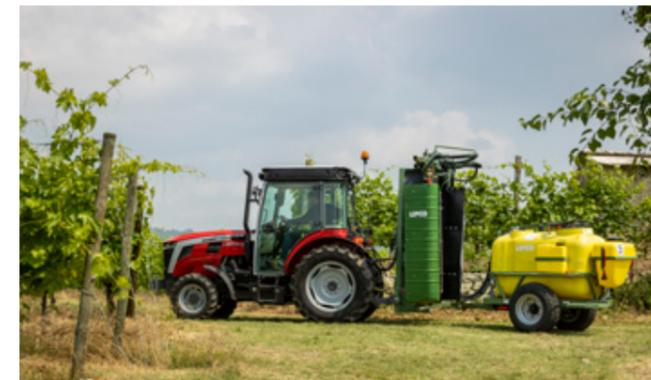
▲ Massey Ferguson prend autant soin de la santé des agriculteurs que ces derniers de leurs cultures, grâce à une filtration de cabine de cat. 4 en option qui garantit leur sécurité lors des opérations de traitement. Facilement activé à l'aide d'un commutateur, le système pressurise la cabine, passant de la cat. 2 à la cat. 4, pour une protection optimale.
