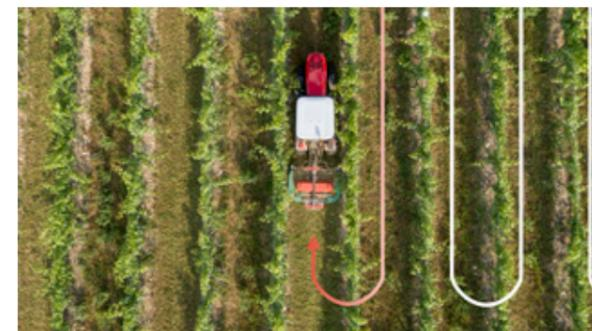
▲ La fonction SPEEDSTEER permet à l'utilisateur de régler le rapport de direction, pour des manœuvres plus simples et plus rapides en fourrière.
