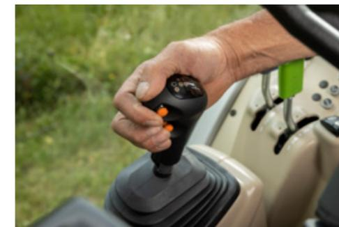
▲ Nouveau levier de vitesses avec commande par câble pour un fonctionnement fluide.
