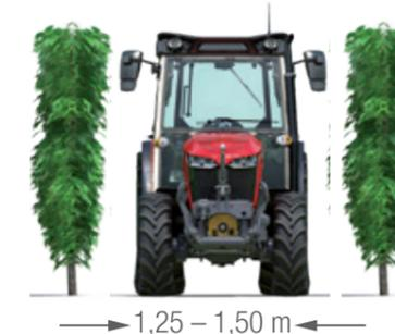
Disponible à partir de 1,25 m de large, le MF 3SP est destiné aux vignobles plus aérés. Doté d'une cabine plus spacieuse, il délivre une puissance de 75 à 120 ch.
