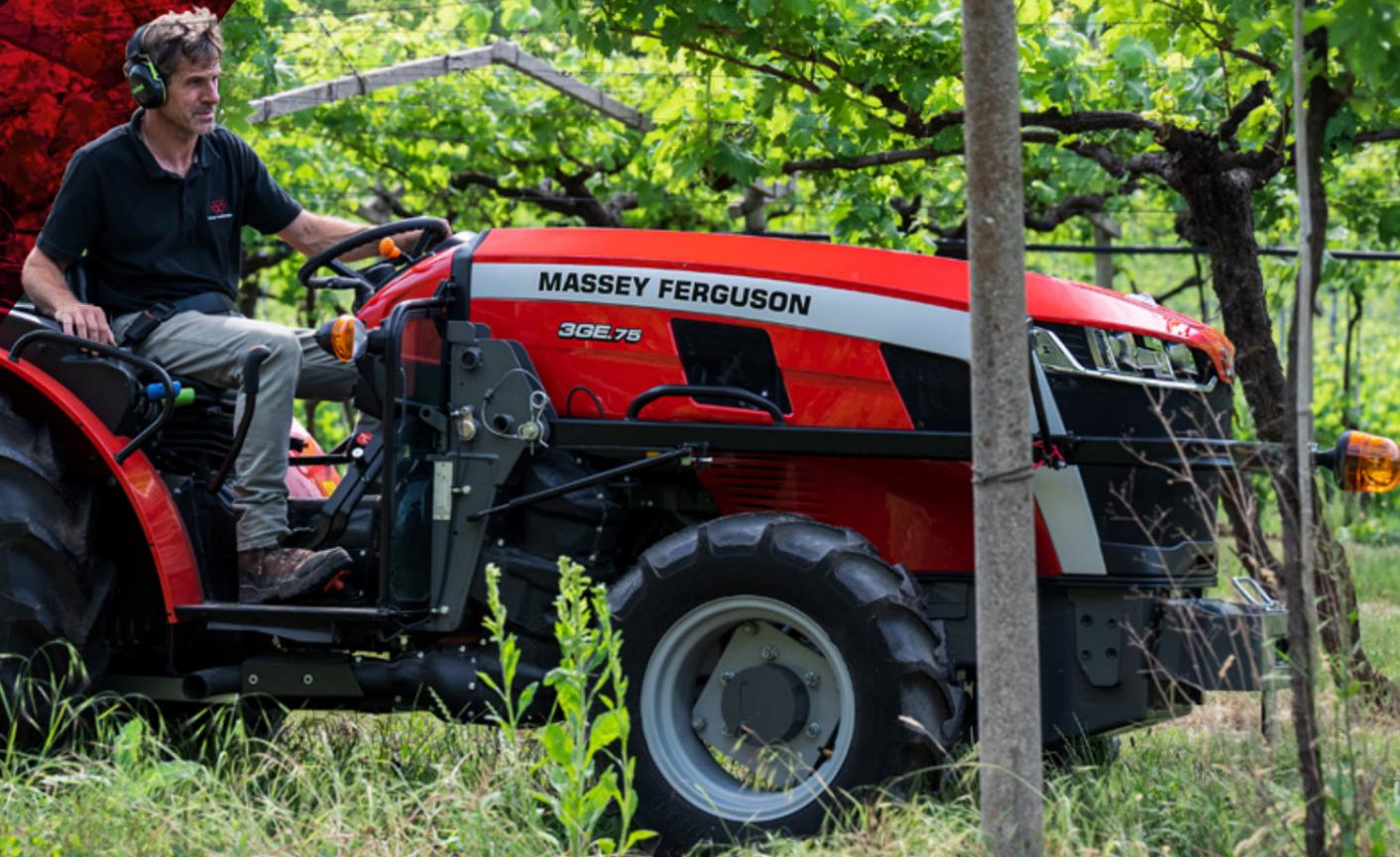
LES TRACTEURS D'ENTRÉE DE GAMME DE 75 CH DE LA SÉRIE MF 3 SPÉCIALISÉE SONT ÉQUIPÉS DU DERNIER MOTEUR 4 CYLINDRES DE 3,4 LITRES STAGE V. TOUT COMME LES MODÈLES PLUS PUISSANTS, ILS SONT DISPONIBLES EN VERSION ESSENTIEL.
