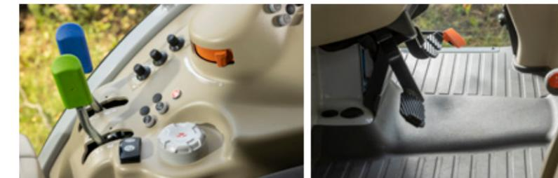
▲ La nouvelle commande électronique de relevage (ELC), de série sur la version Efficient et en option sur la version Essentiel, offre précision et simplicité d'utilisation.
