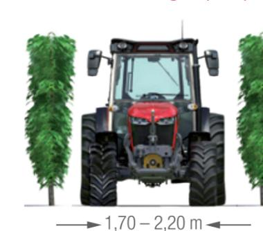
Disponible à partir de 1,70 m de large, le MF 3WF dispose de ponts avant et arrière plus larges et s'avère idéal pour les vignes de coteaux ou les vergers. Disponible de 75 à 120 ch, ou jusqu'à 105 ch en version plateforme.
