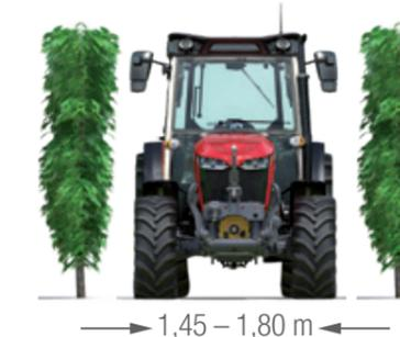
Disponible à partir de 1,45 m de large, le MF 3FR est idéal pour les vignobles et les vergers plus espacés. Tracteur plus imposant doté d'un pont avant plus large. Disponible de 75 à 120 ch, ou jusqu'à 105 ch en version plateforme.
