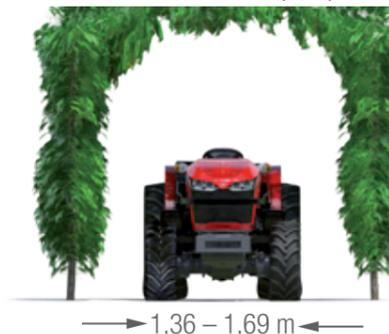
Disponible à partir de 1,36 m de large, la version plateforme est idéale pour le travail sous des arbres, dans des tunnels et des vignobles couverts. Le modèle surbaissé MF 3GE délivre 75 à 105 ch.
