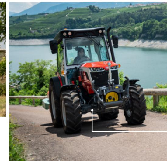
◀ La suspension du pont avant améliore encore davantage le confort sur route et sur terrains irréguliers, tout en limitant les chocs et les secousses.
