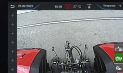
► **Mode vidéo** – Les images provenant de l'une des quatre caméras embarquées peuvent être affichées sur l'écran, ce qui permet au conducteur d'atteler plus facilement et en toute sécurité les outils à l'arrière du tracteur.
