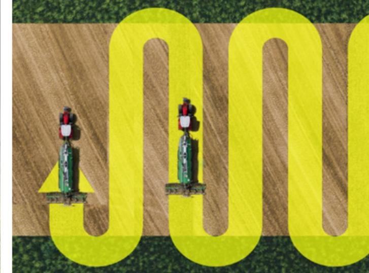
▲ **LA FONCTION SPEEDSTEER** réduit l'effort de l'utilisateur et facilite les manœuvres pour une productivité optimale. L'utilisateur peut régler le rapport de direction et sélectionner le nombre de tours de volant nécessaires pour obtenir un angle de braquage spécifique.
