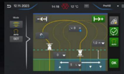
► **MF AutoTurn** – Cette nouvelle fonction de MF Guide dirige automatiquement le tracteur vers la ligne de travail suivante, selon l'un des trois modes de direction adaptés à la tâche. Le nouveau système de gestion des manœuvres en fourrière lance les séquences de manœuvre en fourrière en fonction de la position GPS.
