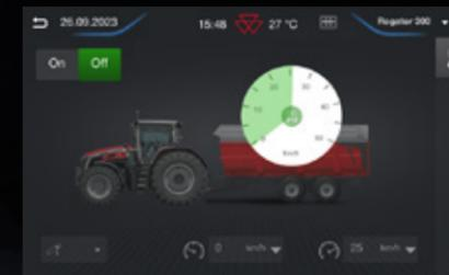
► **BLOCAGE D'ESSIEU AUTOMATIQUE** – Cette fonctionnalité vous permet de définir la vitesse à laquelle l'essieu directeur de la remorque doit se bloquer automatiquement pour ne pas avoir à vous soucier du blocage d'essieu lorsque vous prenez la route. L'opération est également entièrement automatique lorsque vous engagez la marche arrière.
