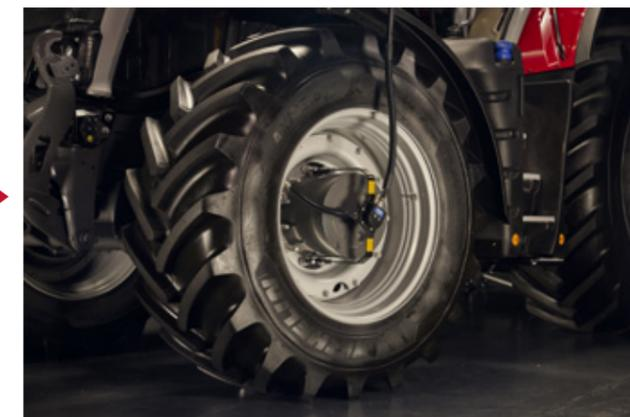
Il est démontré que le système de télégonflage des pneus réduit la consommation de carburant de 10 % à 15 % et limite le tassement superficiel du sol en augmentant l'empreinte de 150 %. Par ailleurs, il augmente l'adhérence et réduit l'usure des pneus.
