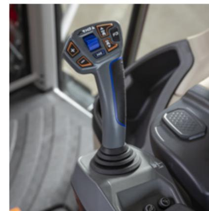
Le MF 5M peut également être équipé d'un **joystick électrohydraulique**, idéalement situé sur l'accoudoir du siège, pour un contrôle précis du chargeur frontal ou d'autres outils spécifiques. Il commande l'inversion du sens de marche, la mémorisation du régime moteur et le passage des vitesses sous-charge et des gammes. Le joystick intégré sur l'accoudoir maximise la précision et le confort lors des opérations de manutention.
