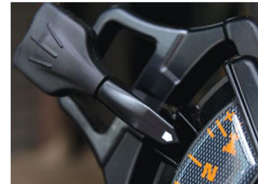
Il suffit de déplacer le **levier de vitesse en T** vers l'avant ou l'arrière pour passer d'un rapport sous-charge à l'autre. Pour changer de gamme, il suffit d'appuyer sur le bouton de sélection tout en déplaçant le levier en T vers l'avant ou vers l'arrière. Non disponible avec le joystick électrohydraulique.
