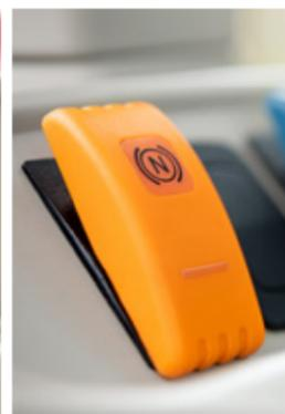
**La fonction neutre à la pédale de frein** (en option) actionne simultanément l'embrayage dès que la pédale de frein est enfoncée. Cela facilite l'utilisation tout en augmentant l'efficacité et la commodité et s'avère particulièrement utile lors des opérations de manutention au chargeur.
