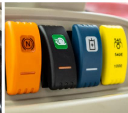
Pour les applications nécessitant des vitesses d'avancement particulièrement lentes, un contrôle ultra-précis est assuré par des **vitesses rampantes supplémentaires** qui permettent d'atteindre une vitesse de 100 m/h à 1 400 tr/min.
