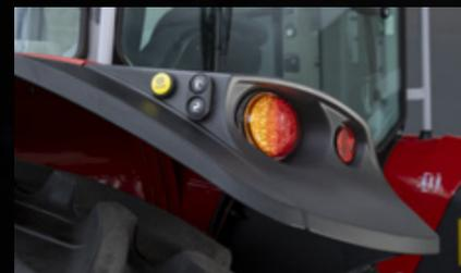
En plus de la commande de prise de force, les commandes externes situées sur les ailes facilitent la montée et la descente du relevage arrière lors de l'attelage ou du dételage d'outils.
