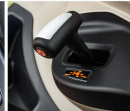
Inversion lente ou rapide : avec la fonction **Comfort Control**, sélectionnez l'agressivité de l'inverseur sous 10 niveaux de réglage depuis l'écran du tableau de bord numérique.
