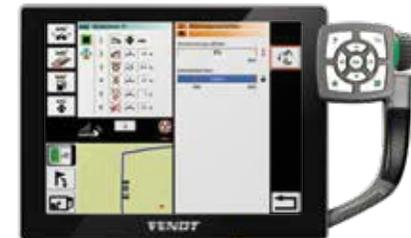
Le Varioterminal™ affiche le niveau du liquide de refroidissement, de même que celui de la contamination du filtre à air.
