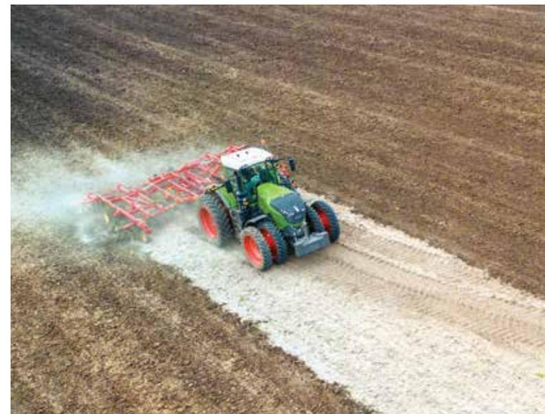
Grâce au SGT et au contrôle automatique de puissance maximale 2.0, le tracteur adapte de façon optimale la vitesse du moteur à celle du déplacement.
