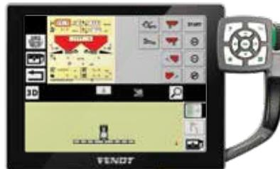
Le Varioterminal, la manette multifonctions, le contrôle d'accessoires Variotronic peuvent contrôler tous les accessoires compatibles ISOBUS.
