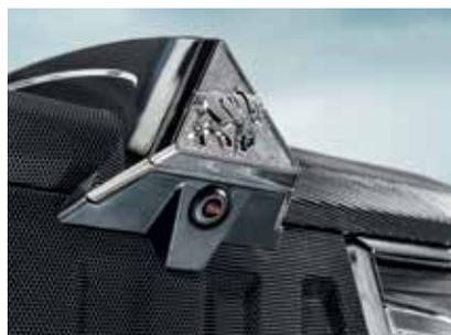
Une nouvelle caméra intégrée au capot capte des images de l'attelage avant pour les transmettre au Varioterminal. Cela facilite le travail avec l'accessoire monté à l'avant.
