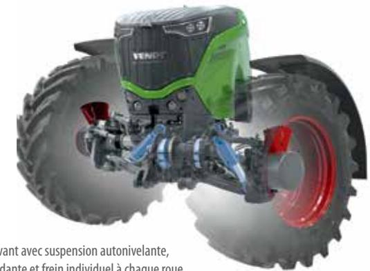
Essieu avant avec suspension autonivelante, indépendante et frein individuel à chaque roue.
