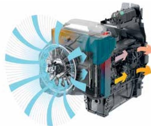
Grâce aux vitesses minimisées du ventilateur et à la précision de la fabrication (faibles tolérances pour les espacements), le CAS atteint une capacité élevée de refroidissement à un niveau de bruit sensiblement réduit.
