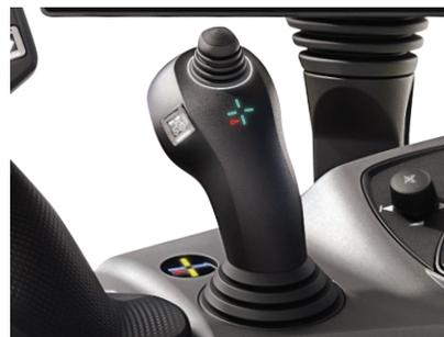
La nouvelle manette multifonctions 3L contrôle les fonctions du chargeur. Elle permet aussi d'inverser la direction du déplacement.
