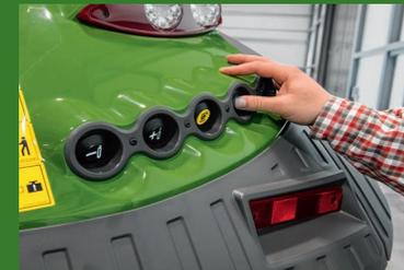
Le relevage arrière, la PdF et un distributeur peuvent être commandés depuis l'un ou l'autre des garde-boue arrière.
