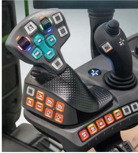
*Commande par pédale ou par manette multifonctions : Le mode de conduite peut être sélectionné individuellement. La vitesse peut être contrôlée à l'aide de la pédale ou de la manette multifonctions. Changez le sens du déplacement soit avec la manette multifonctions, soit avec le levier de marche arrière avec fonction arrêt et départ intégrée.*
