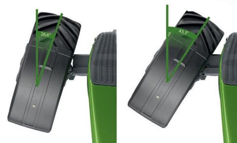
En bout de champ ou lors des travaux avec le chargeur, vous bénéficiez de la conduite **VarioActive\***. Elle permet d'obtenir un rayon de braquage maximal en un seul tour de volant.
