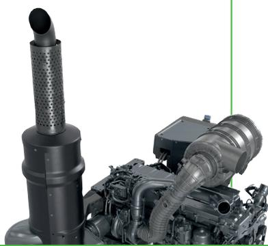
Le puissant moteur quatre cylindres maximise l'efficacité grâce au système de gestion du tracteur (TMS). Celui-ci règle la vitesse désirée et s'ajuste automatiquement pour obtenir la performance optimale.
