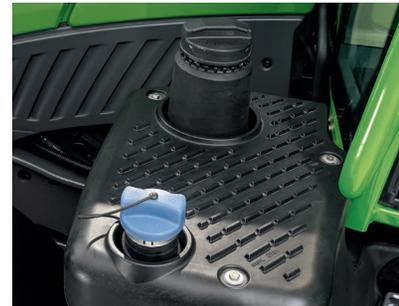
Le grand réservoir contient 55 gallons de diesel et 6 gallons de DEF pour assurer plus d'heures au travail. Travaillez plus longtemps sans faire le plein. Pratique : L'ouverture de remplissage du diesel et celle du DEF sont situées du même côté du tracteur.
