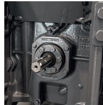
*La CVT du Fendt Vario présente un design simple et éprouvé. Il élimine les composants qui s'usent comme les mécanismes d'embrayage. La prise de force tourne indépendamment de la transmission.*
