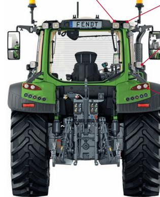
Phare de travail arrière monté sur le garde-boue (DEL – 4 000 lm en option)
