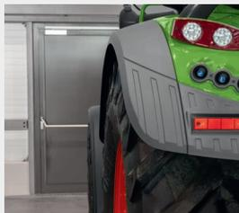
Protection complète des roues avec garde-boue extra large à l'arrière et sur les côtés pour éviter les salissures.
