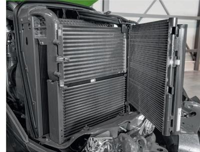
Excellente accessibilité pour l'entretien : L'alimentation directe en air et l'accès facile au condensateur climatique et aux refroidisseurs repliables rendent l'ensemble extrêmement facile à entretenir. Le fond plat du radiateur assure une faible sensibilité à la saleté.
