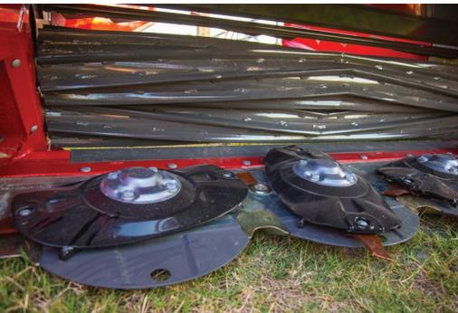
**LE DESIGN MODULAIRE DU LAMIER RAZOREDGE** permet de démonter individuellement chaque engrenage et le baladeur adjacent sans défaire la barre de coupe. Le design de l'engrenage droit offre aussi un profil plus mince pour permettre de faucher plus ras avec moins de scalpage.
