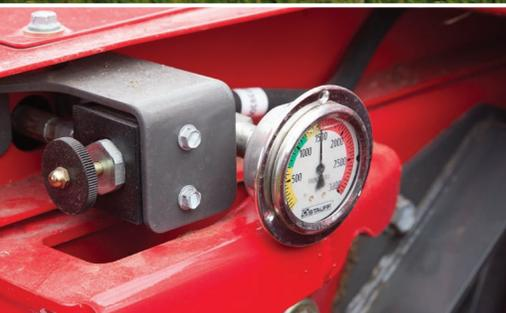
Tensionnement hydraulique du rouleau de conditionnement sur les 1393 et les 1316S. C'est le premier design sur un modèle remorqué à avoir ce système.
