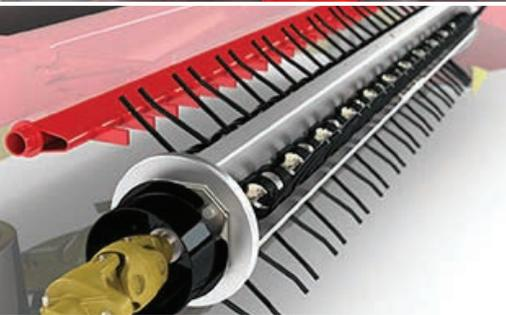
**CONDITIONNEUR À DENTS** Un bon choix pour les fourrages d'herbacées, ce conditionneur utilise des dents qui tournent à grande vitesse pour conditionner la culture efficacement et la forcer à frotter sur le panneau conditionneur. En retour, cela érafle la cire des tiges et leur permet de sécher plus rapidement.
