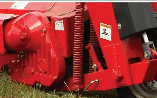
**DES RESSORTS EN TENSION** supportent la barre de coupe dans différentes conditions au champ afin d'accroître l'efficacité et pour réduire l'usure.
