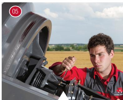
05 Réglage de l'embrayage à friction du volant.
