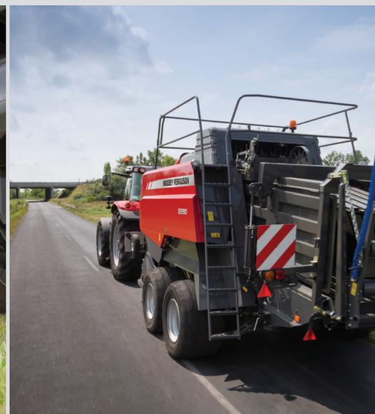
L'essieu tandem contribue à une conduite confortable sur route d'un champ à l'autre.
