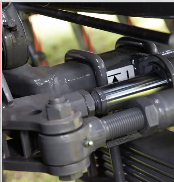
Dispositif de blocage hydraulique de l'essieu arrière.
