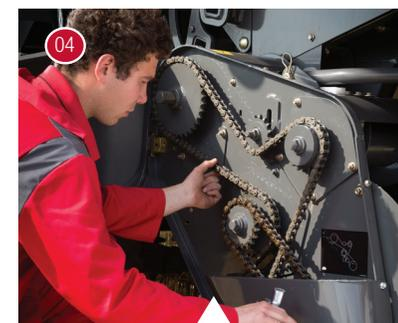
04 Contrôle de la tension des chaînes du ramasseur.
