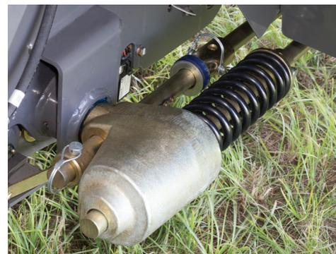
Une suspension à ressort de compression conçue pour un fonctionnement à grande vitesse équipe le ramasseur.
