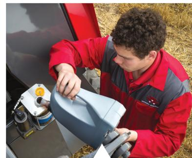
Remplissage de la lubrification automatique des chaînes.
