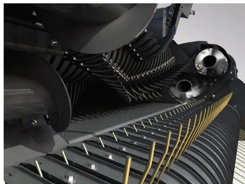
Les presses à balles cubiques sont également équipées de quatre vis de convergence pour assurer une alimentation homogène du rotor ProCut.
