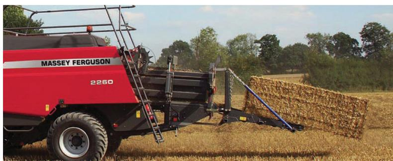
Le système de pesage intégré pèse les balles dès qu'elles sortent du canal et passent sur la rampe à rouleaux.
