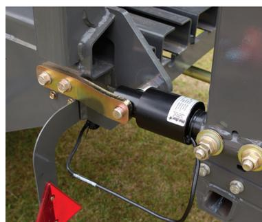
Des cellules de charge ultra-précises pour le système de pesage des balles intégré.
