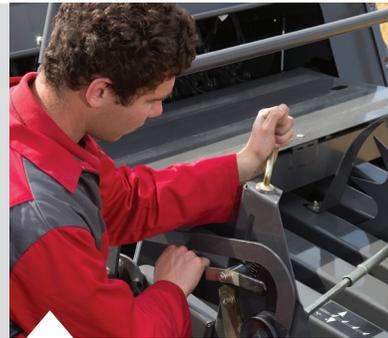
Réglage simple et fiable de la longueur des balles. Montée au centre du canal de compression, la roue étoilée déterminant la longueur des balles flotte avec le volet supérieur de la chambre de compression, ce qui garantit une traction efficace dans toutes les conditions de récolte pour une précision accrue de la longueur des balles.
