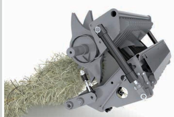
*Parfois, les surcharges peuvent occasionner des pertes de temps dues aux bourrages. Voilà pourquoi nous incorporons le HydroFlex Control. C'est la partie avant flexible du plancher de la chambre où le passage est le plus étroit. Cette section bouge vers le haut ou le bas grâce à une suspension en caoutchouc. Puisque moins de temps est consacré à nettoyer les bourrages, plus de travail est effectué.*
