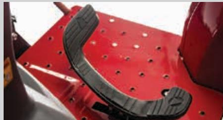
La transmission hydrostatique dispose d'une **pédale de commande à bascule**. Un appui avec le bout du pied vous permet d'avancer. Pour reculer, pressez avec le talon. Retirez votre pied de la pédale et le tracteur s'arrête. Si intuitive, même l'opérateur le plus inexpérimenté peut maîtriser un tracteur de la Série E en un rien de temps.
