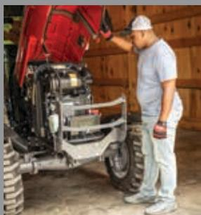
**Massey Ferguson « s'ouvre » complètement** à l'entretien et au service. Le jambe de force à gaz permet de soulever facilement le capot. À noter, l'accès facile à tous les points de service à partir du sol.
