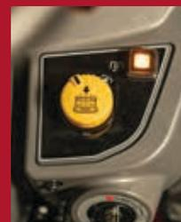
La Pdf arrière de 540 tours/min de série et la Pdf ventrale de 2 000 tours/min en option sont à commande électrohydraulique. Cela permet une plus grande douceur et une mise en marche sans claquement désagréable. La modulation SoftStart réduit les secousses brusques, diminue l'usure et réduit les risques d'immobilisation.
