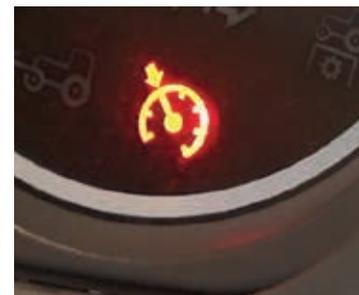
**Le régulateur de vitesse accompagne de série** la transmission hydrostatique. Réglez simplement la vitesse de travail désirée, engagez et démarrez. L'appui sur la pédale de frein ou sur la pédale de marche avant désengage le système.
