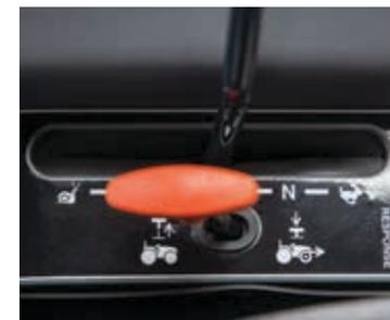
**Obtenez une traction supplémentaire pour les travaux** et les conditions difficiles grâce aux quatre roues motrices sur demande. Poussez simplement le levier vers le bas pour l'engager. Tirez-le vers le haut pour le désengager.
