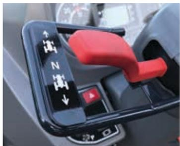
**Placé sur la colonne de direction,** le levier de l'inverseur permet de changer de direction rapidement et facilement. C'est idéal pour le travail au chargeur.
