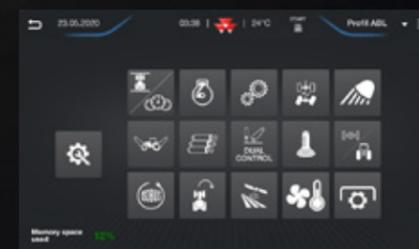
Des fonctions regroupées pour optimiser la gestion de votre tracteur, notamment la transmission, le moteur et le système hydraulique. Sans oublier le remarquable système Dual Control, qui offre le contrôle des relevages avant et arrière de manière simultanée. Ce système ajuste également la profondeur du relevage arrière ainsi que celle de la roue de jauge d'une charrue par exemple.
