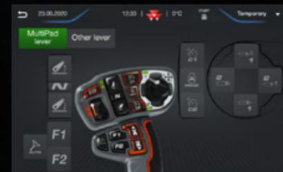
Choix de commande MultiPad pour ISOBUS – Les outils ISOBUS peuvent être contrôlés directement avec le joystick MultiPad. Tout contrôler (tracteur et outil) à partir d'un seul levier est bien plus simple que d'utiliser différents leviers et affichages.
