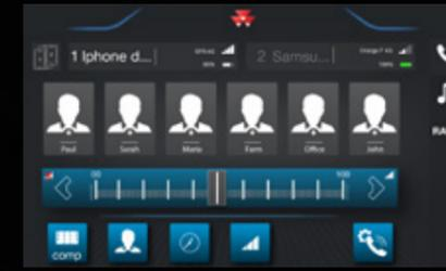
Accès aux fonctions de la radio sur le Datatronic 5 : comme dans une voiture, connectez simplement vos appareils par Bluetooth, via le port USB ou la prise auxiliaire, avec la possibilité de synchroniser plusieurs smartphones. Mémorisez des stations de radio, recevez et passez des appels, et bien plus encore.
