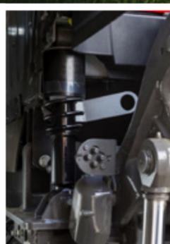
**LA SUSPENSION DE CABINE MÉCANIQUE ACTIVE** est dotée de deux amortisseurs pilotés et réglables sous 3 configurations depuis le poste de conduite.
