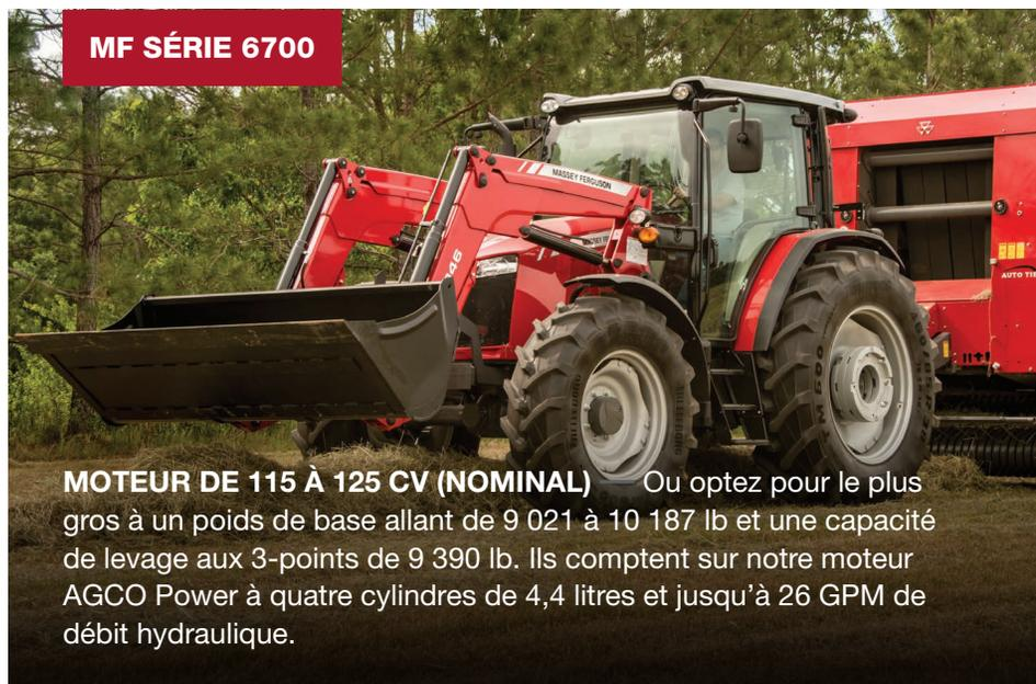
**MOTEUR DE 115 À 125 CV (NOMINAL)** — Ou optez pour le plus gros à un poids de base allant de 9 021 à 10 187 lb et une capacité de levage aux 3-points de 9 390 lb. Ils comptent sur notre moteur AGCO Power à quatre cylindres de 4,4 litres et jusqu'à 26 GPM de débit hydraulique.
