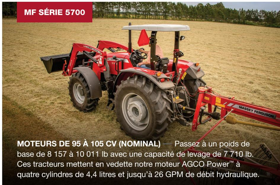
**MOTEURS DE 95 À 105 CV (NOMINAL)** — Passez à un poids de base de 8 157 à 10 011 lb avec une capacité de levage de 7 710 lb. Ces tracteurs mettent en vedette notre moteur AGCO Power™ à quatre cylindres de 4,4 litres et jusqu'à 26 GPM de débit hydraulique.
