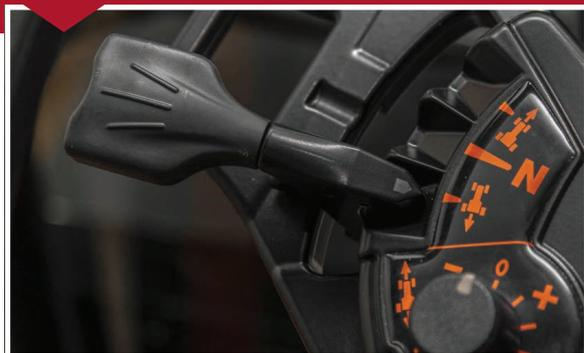
Tous les tracteurs de la Série Global comptent un bouton de commande d'embrayage sur le levier de vitesses. Il permet des changements de vitesse simples, sans pédale d'embrayage. Pour changer de vitesse sur les tracteurs de la Série Global, appuyez sur le bouton de commande d'embrayage et maintenez-le enfoncé, passez à la vitesse souhaitée, puis relâchez-le.
